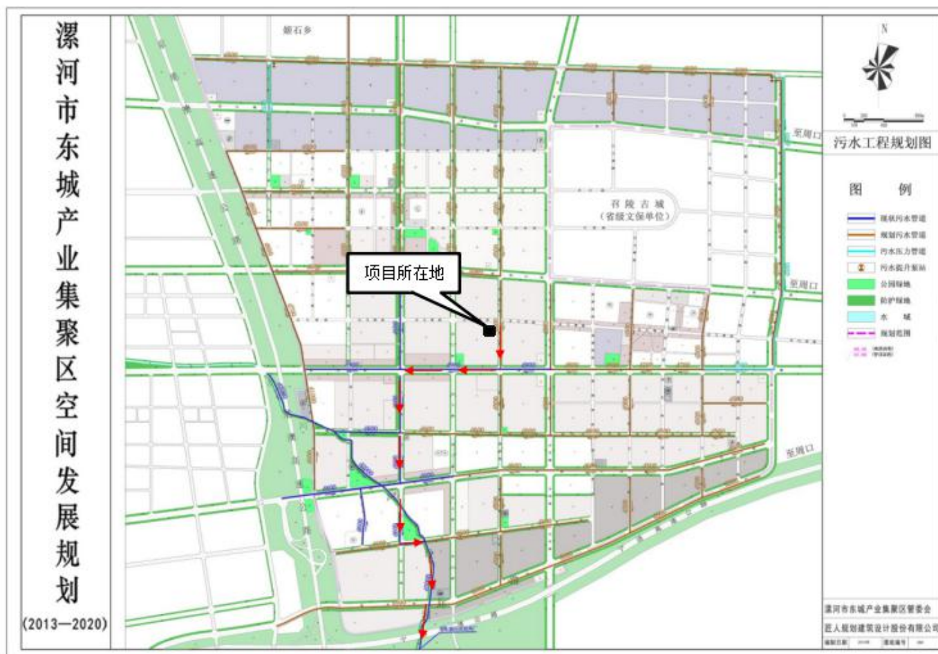
附图十一 漯河市东城产业集聚区发展规划污水工程及本项目污水走向示意图
