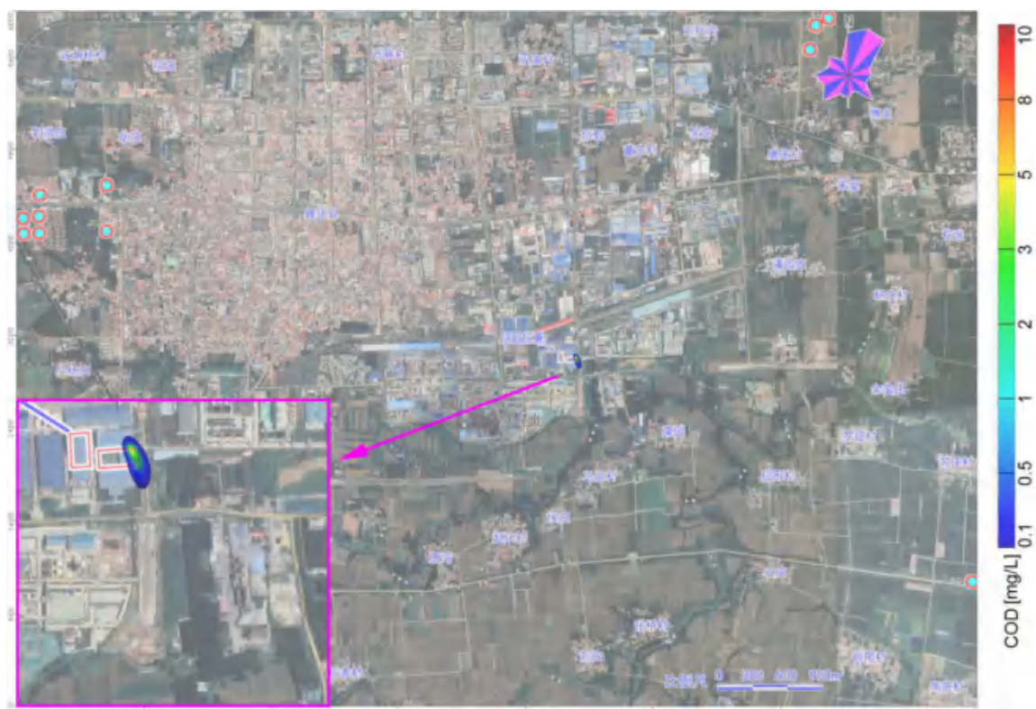
图 5.4-14 项目非正常工况渗漏 1000 天后 COD 污染物影响范围图
