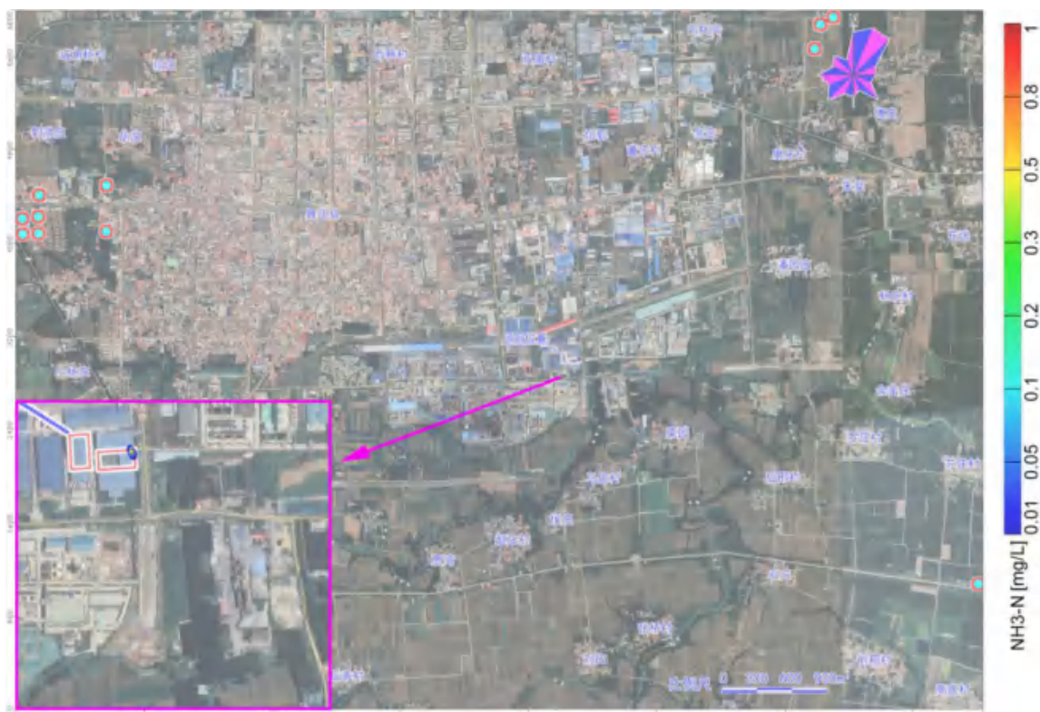
图 5.4-18 项目非正常工况渗漏 100 天后氨氮污染物影响范围图
