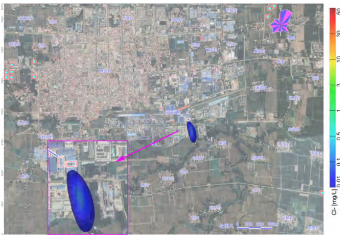
图 5.4-35 项目事故工况渗漏 7300 天后氯离子影响范围图
