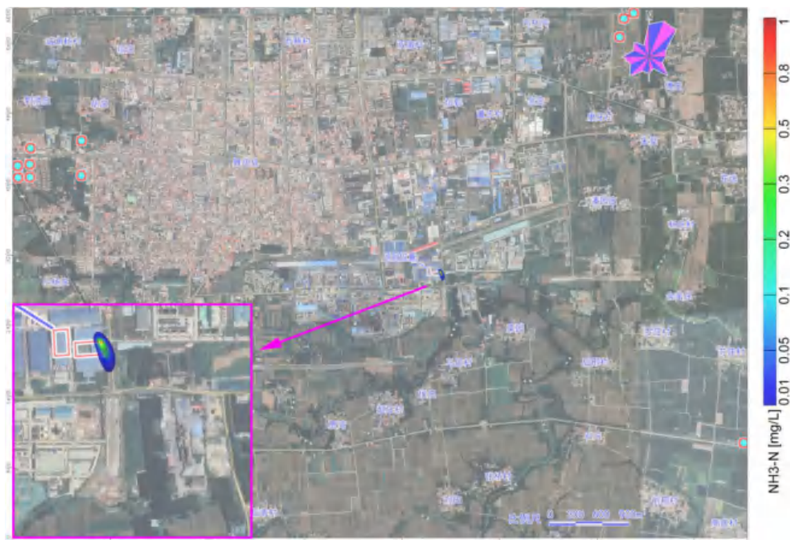
图 5.4-20 项目非正常工况渗漏 1000 天后氨氮污染物影响范围图
