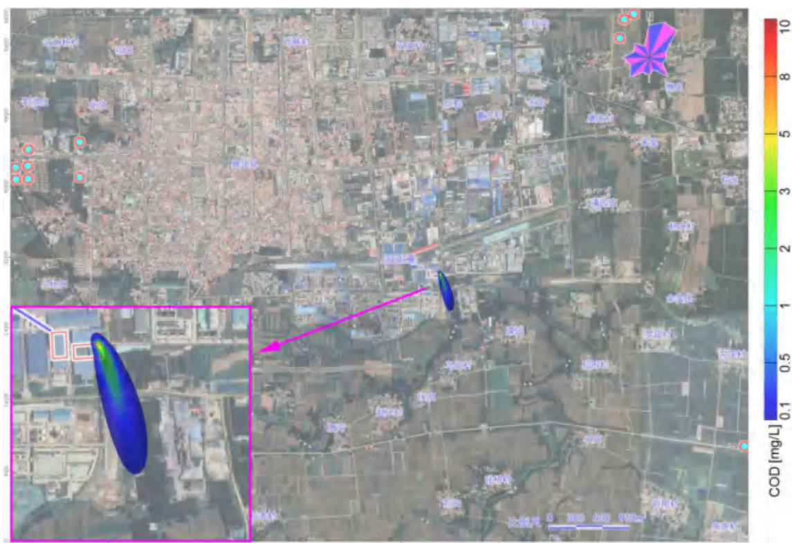
图 5.4-16 项目非正常工况渗漏 7300 天后 COD 污染物影响范围图
