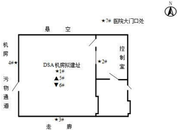
图 8.3 DSA 三机房监测点位布设图
