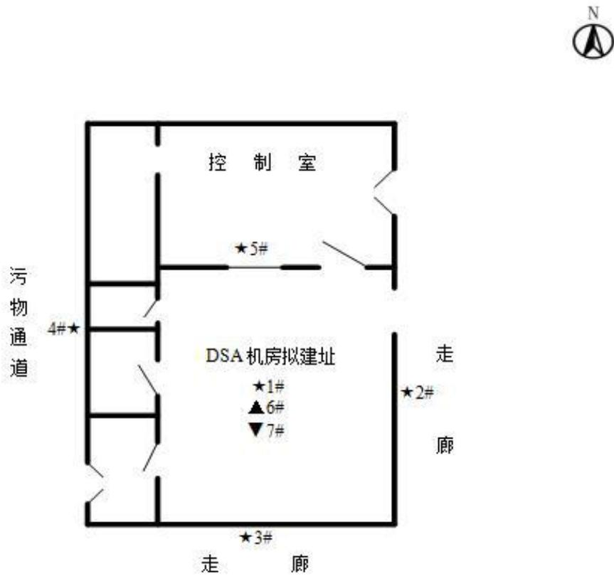
图 8.2 DSA 二机房监测点位布设图
