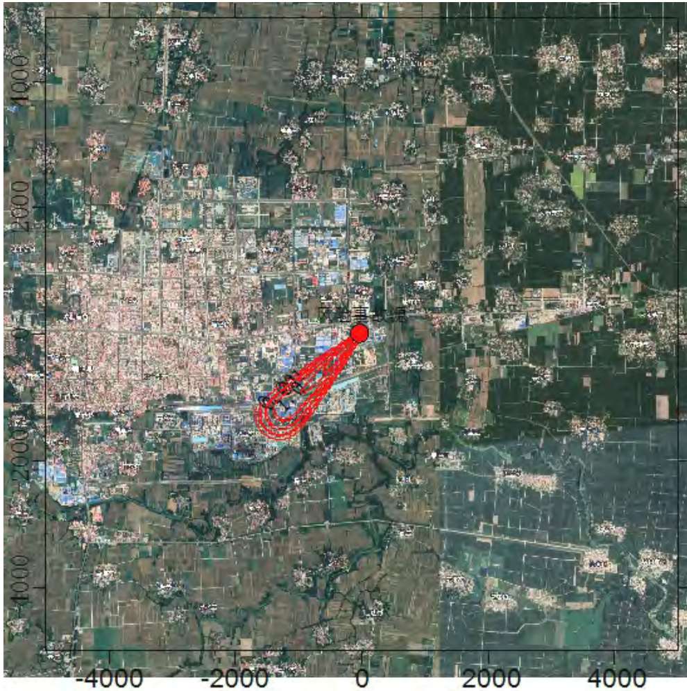
图 6-7 最不利气象条件下甲醇钠泄漏预测网格点计算结果分布图
