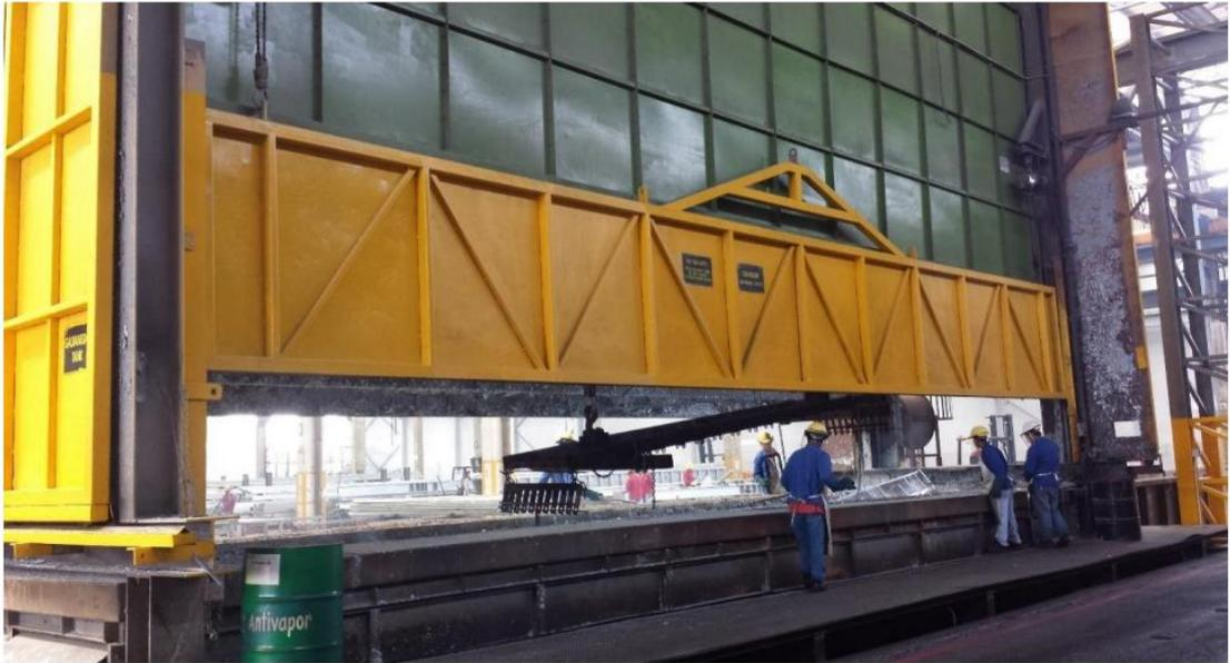
图 7-9 工程拟采用的固定罩——侧边除灰窗开启（网上截图）
