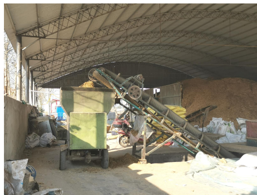
搅拌混合粉尘未收集处理
