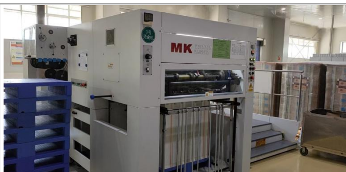
现有厂区生产车间-烫金工序
