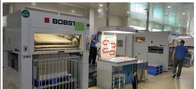
现有厂区生产车间-模切工序
