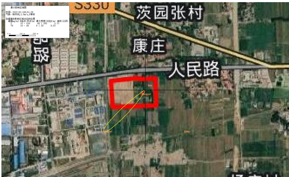
图 6.8-4 最常见气象条件下丙类仓库火灾事故 SO 2 最大影响范围图
