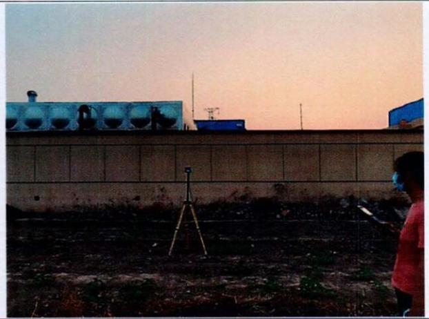
升压站东围墙外电磁监测
